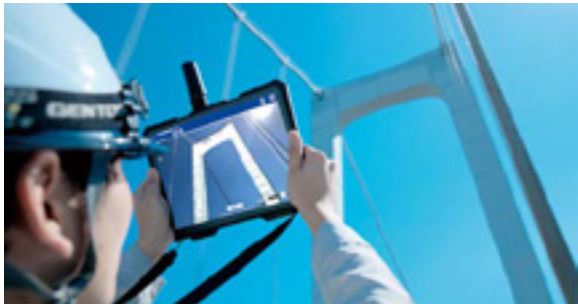
写真-3 BIM/CIMモデルとMR(複合現実)技術を活用した長大橋点検支援ツール(開発中)
